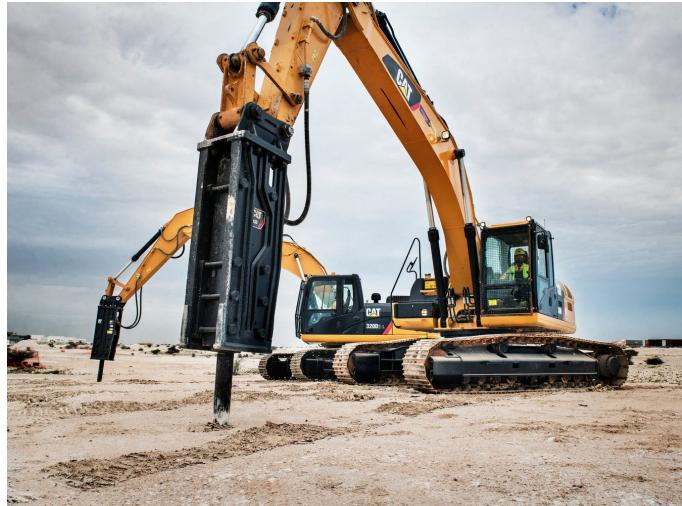
ной силой удара за счет того, что усилие рукояти и усилие гидромолота направлены вдоль одной линии. Кроме этого, использование верхнего крепежного кронштейна позволяет уменьшить усилия и изгибающие моменты, действующие на конец рукояти, и соответственно, на конструкцию машины.
