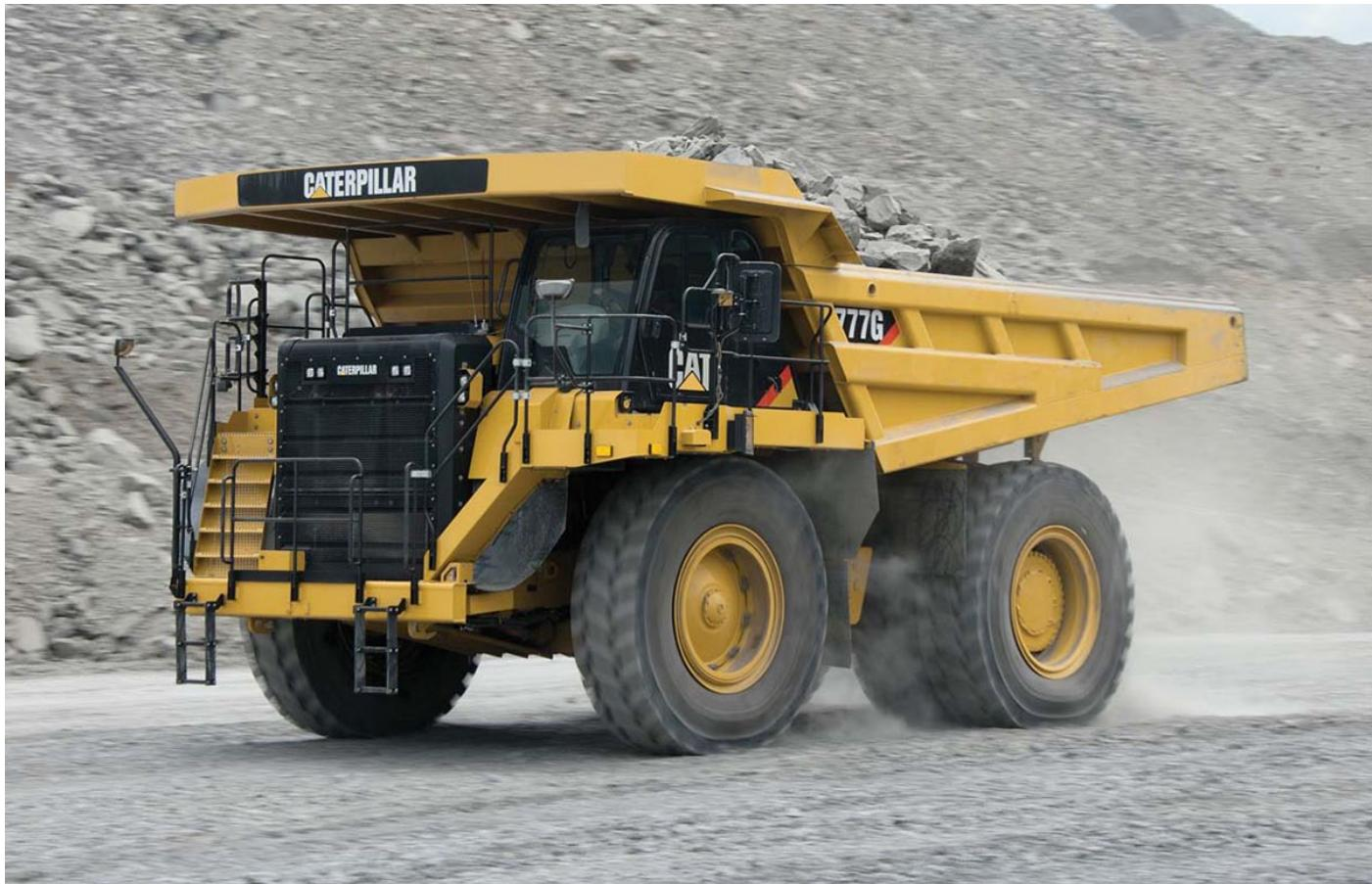
управления коробкой передач и повышенной скорости хода самосвал Cat 777G способен осуществлять более быструю и продуктивную транспортировку груза, так как усовершенствованная система регулировки тяги облегчает движение машины по влажному грунту. Данная система имеет обратную связь с системой рулевого управления для контроля пробуксовки колес при преодолении поворотов.
