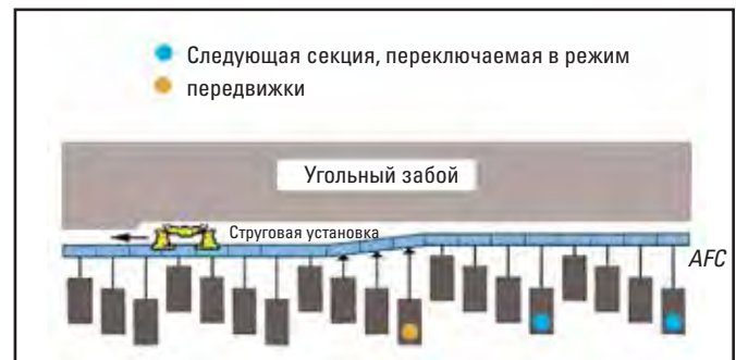
Принцип пошагового метода резания стругом
