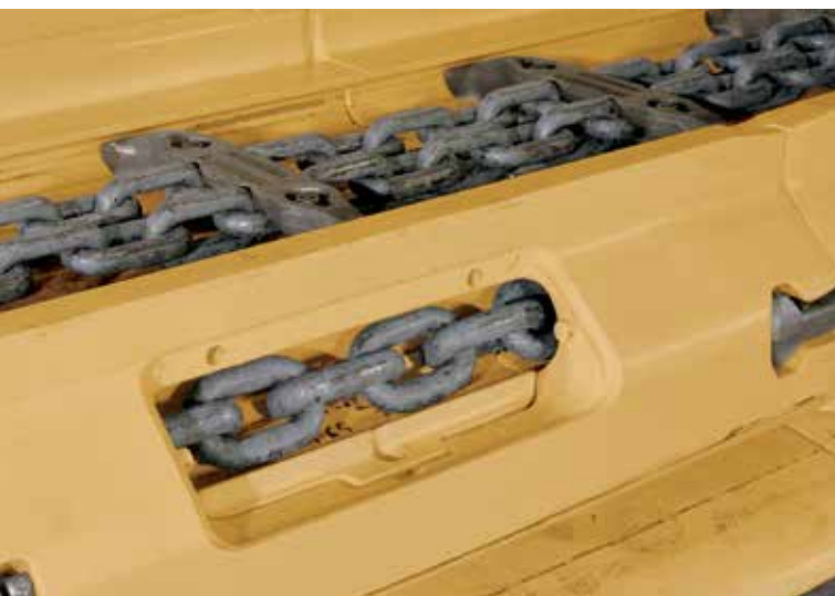
Инспекционные люки в струговых направляющих обеспечивают быстрый и простой доступ к струговой цепи
